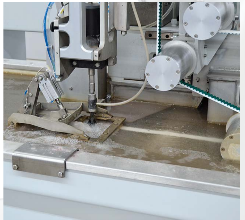
Unter dem Zahnriemen im Bereich des Schneidkopfes befindet sich eine schräg angeordnete Verschleißplatte, die den Strahl ablenkt und so verhindert, dass das Untertrum vom Wasserstrahl getroffen wird. Ein pneumatisch betätigter Niederhalter fixiert den Zahnriemen während der Bearbeitung.
