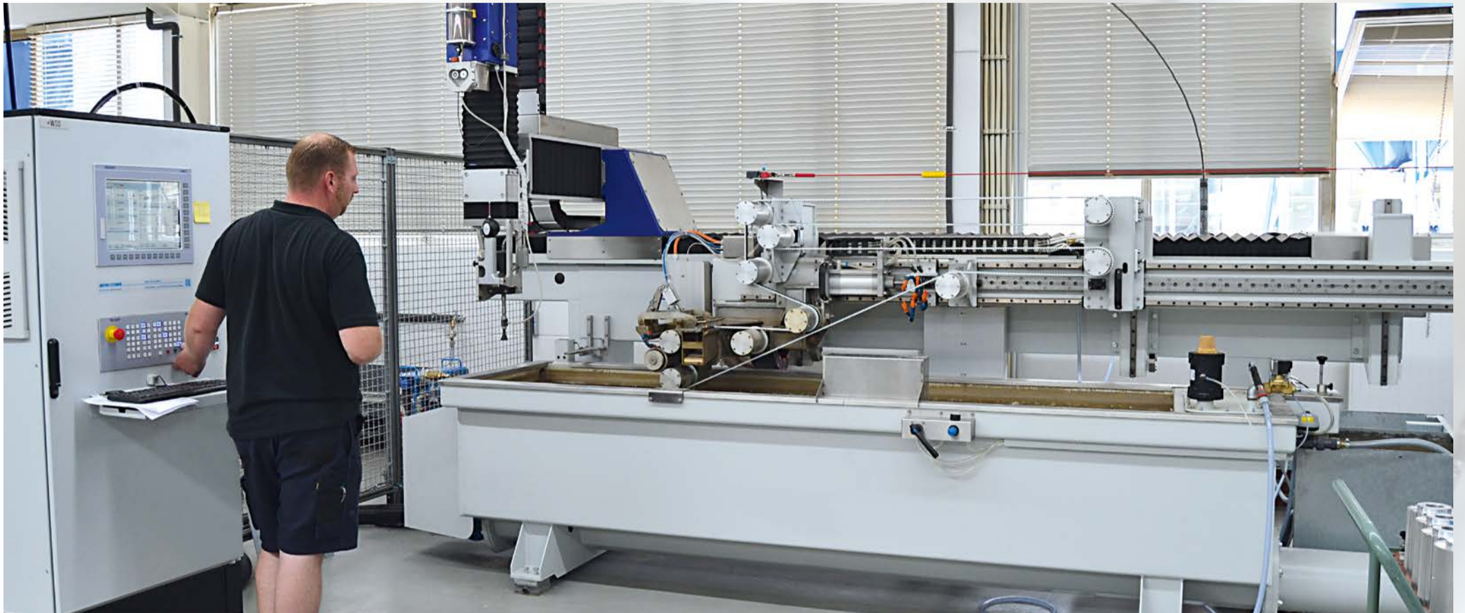
Seit wenigen Wochen in Betrieb: Die neu entwickelte Wasserstrahlschneidanlage reduziert die Schneidkosten und die Produktionszeit.
