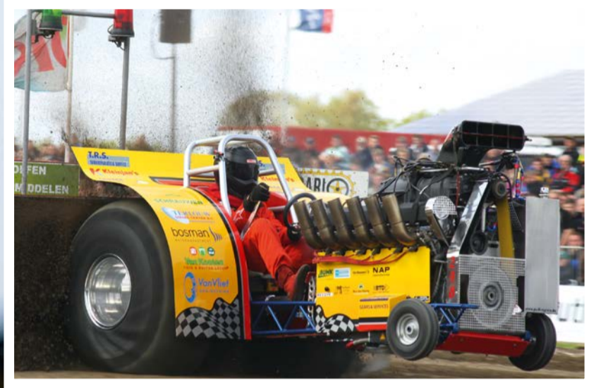
Das Gebläse für die Motoraufladung des Challenger wird mit einem Zahnriemen des Typs CONTI® SYNCHROCHAIN CARBON angetrieben.
