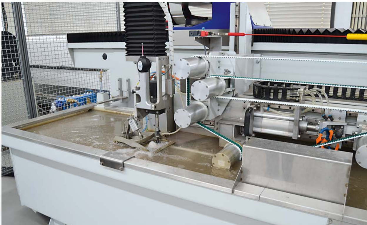
Der Schneidprozess läuft vollautomatisch unter Wasser ab. Die verstellbaren Umlenkscheiben erweitern das Riemenlängenspektrum auf bis zu 14,5 Meter Länge.
